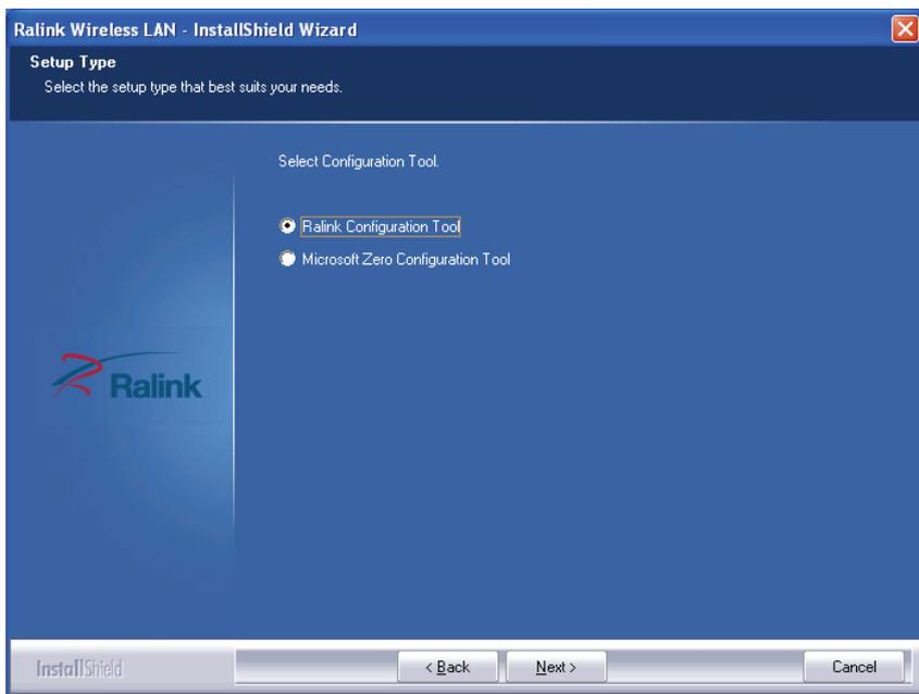
8. Здесь вы сможете выбрать конфигуратор для настройки беспроводного контроллера. Рекомендуется выбрать 'Ralink Configuration Tool', который обеспечивает полный доступ ко всем функциям данного устройства. Если вы предпочитаете использовать штатный конфигура-тор Windows XP или Vista, выберите 'Microsoft Zero Configuration Tool', затем нажмите 'Next'.
