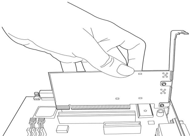
1. **ВЫКЛЮЧИТЕ КОМПЬЮТЕР**, снимите крышку и установите контроллер беспроводной сети в свободный слот PCI вашего компьютера, затем установите крышку на место.
