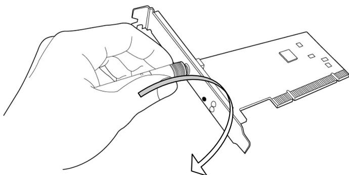
2. Вращая по часовой стрелке, подключите антенну к разъему антенны на контроллере.
